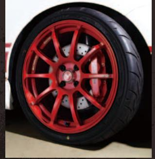
右 リムサイズは17×7.5Jのワンサイズ設定、PCD98mmの4穴で、レーシングレッドの価格設定は5万円(+税)となっている。純正オーナメントを装着できるオーナメントリングは、別売り。下 全カラーにADVAN Racing RS II専用のスポークロゴステッカーが付属する。スポークデザインは、センター下がりのコンケイブスポークが採用されている。
