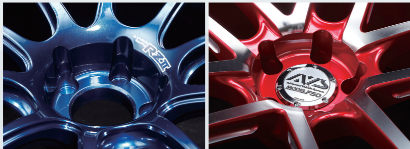
アドバンレーシングシリーズは、センターキャップレスが標準。というも、センターキャップのことを考えてデザインすると、このようなセンターの落とし込みができないから。逆にAVSシリーズは、センターキャップまでデザインに取り込んだ上質さが特徴。そのためセンターの落ち込みは種々なモデルが多い。
