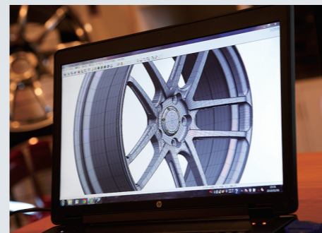
CADで基本的な設計をすれば画面上に3Dで表示できるようにもなるが、萩原さんはこの3Dの画像をあまり信用していない。光のあたり方や陰影によって、ホイールの見え方が違って来るからだ。
