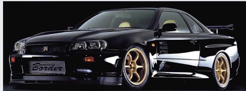
今となっては当たり前のようにデザインされるコンケイブだが、そのルーツはアドバンレーシングRGのGT-Rデザイン。フェンダー内にギリギリ収まるリム幅とインセットで設計することで、センターへの落とし込み角度を極限までつけたモデルだ。
