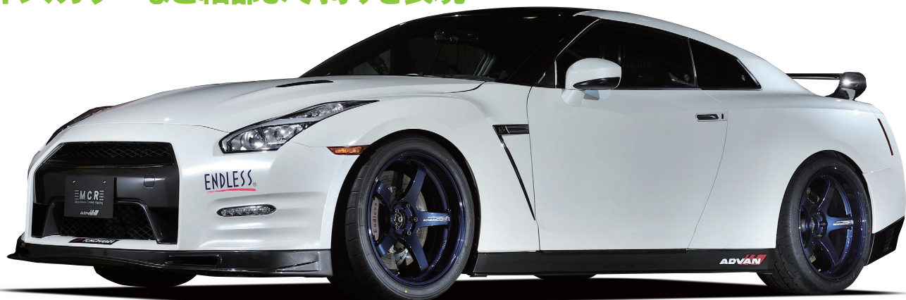
ホワイトのボディに落ちつきのあるブルーのホイールの組み合わせはベストマッチ。撮影車はフロント10.5J×20インセット24mm、リヤ11J×20インセット5mmをセット。深リムも美しい
