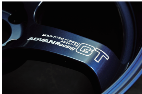
プレミアム・バージョンのロゴはマシニング仕上げ。横長のデザインは機械が入るギリギリまで掘り込む。見た目にも迫力満点だ
