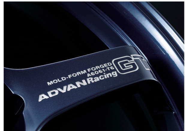
GTのオリジナルバージョンではステッカー仕様となるスポークロゴだが、プレミアムバージョンではマシニング加工による彫り込みで表現。その立体的な演出とプレミアムバージョン専用カラーが相まって、装着マシンをプレミアムチューンドへと昇華する。
